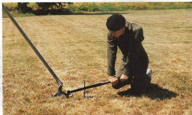
Fig. 27 - Arrachage d'un piquet au moyen de l'arrache piquet
